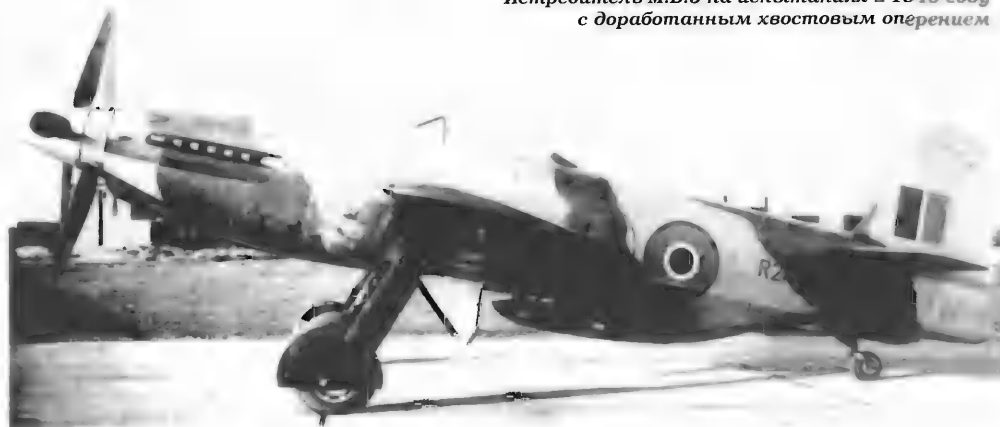
Истребитель М.В.5 на испытаниях в 1945 году с доработанным хвостовым оперением
